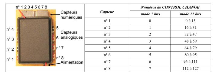
En mode 7 bits, les informations des capteurs sont récupérées sur les CONTROL CHANGE de 0 à 7. En mode 11 bits, à chaque capteur correspondent 16 numéros de CC. Les valeurs sont reconstituées en prenant en compte le numéro de CC aussi. Le tableau indique les plages de numéros pour chaque capteur.
